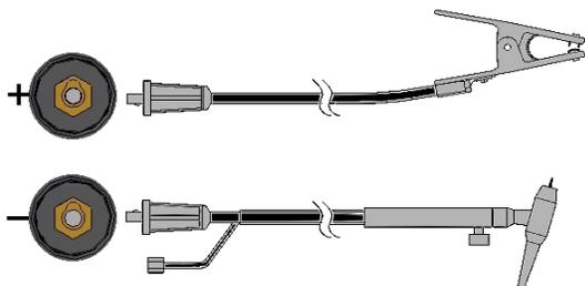
Подключите горелку к терминалу (-), а кабель на деталь подключите к терминалу (+), расположенных на аппарате. Вставьте сварочный разъем, выровняв его так, чтобы выступ ключа входил в ответный паз и поверните его на ¼ оборота по часовой стрелке. В заключение подготовки присоедините газовый шланг к регулятору на балоне Аргоном.
