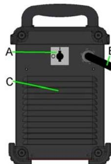
энергопотребление и количество пыли, попадаемое внутрь аппарата. В режиме сварки вентилятор работает, в режиме простоя, если нет сварки 5 минут, вентилятор выключается.
