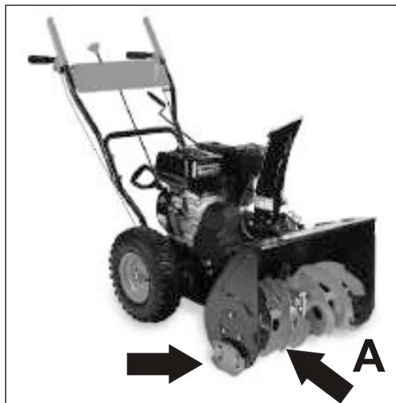
Перед началом работы необходимо отрегулировать опорные лапы. Для предотвращения поломки шнека высоту опорных лап регулируют так, чтоб пластина А находилась над грунтом не менее 1см.
