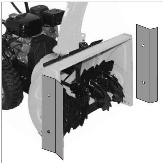
Некоторые модификации снегоуборщика укомплектованы стальными пластинами, которые устанавливаются на боковые стороны снегоуборщика. Они предназначены для увеличения ширины захвата и используются для свежесвыпавшего снега не более 30см.
