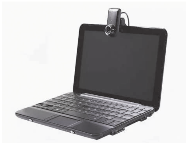
Рис. 1. Пример неудачной установки камеры (вибрация крышки ноутбука передается камере)
